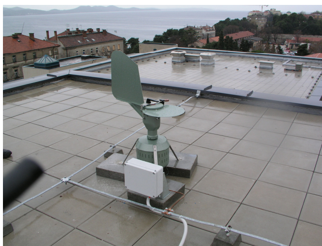
Slika 1. Automatski uzorkivač tipa Burkard na mjernoj postaji Zadar
